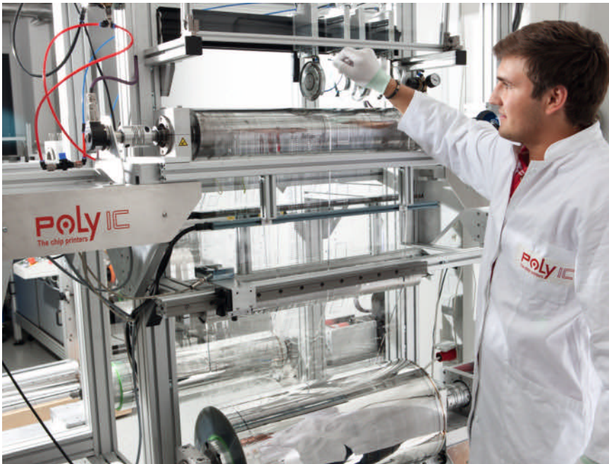
Bild 1. Flexible, leitfähige und transparente Folien auf der Maschine (Bilder 1 bis 3: PolyIC)
